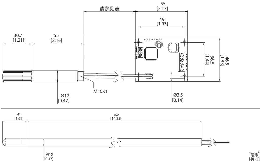
图 5 HMM100 尺寸, 从上到下: 标准和延长的探头主体
